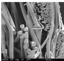
Anti propustnost AntiAllergy látek pro roztoče, alergeny a štěnice je zajištěna nanovláknennou vrstvou, která je uzavřena uvnitř textilní membránou. Technicky tkaniny AntiAllergy jsou trojvrstevné sendviče s prostřední vrstvou nanovláknenné struktury. Vzájemná provázanost jednotlivých vrstev je zajištěné technologií laminátování.
